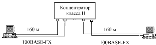
Рисунок 7. Сеть Fast Ethernet максимальной длины
