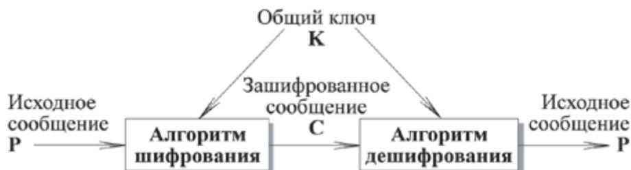
Рис. 2. Общая схема симметричного шифрования
